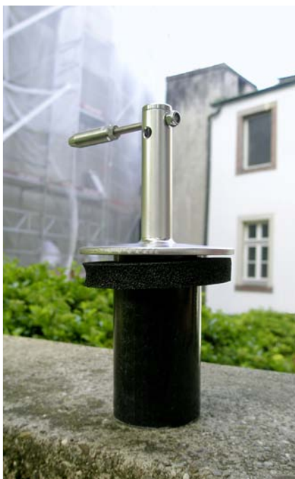
Abstandhalter mit wärmege­däm­mter Stützhülse, Fugendichtring und hohlgebo­gener Grundplatte.
