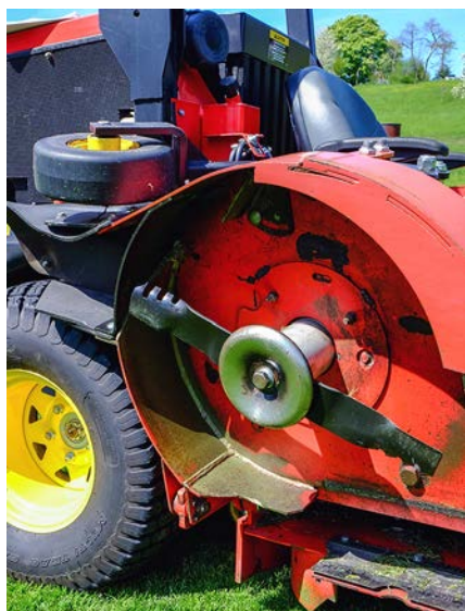
Mulchmäher der Matra AG mit spezieller Messerform.
